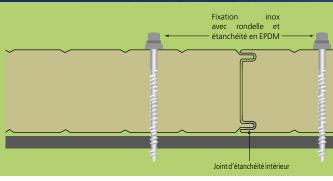
Hipertec® Wall est un panneau sandwich avec une isolation en laine de roche. Il est incombustible et répond aux exigences actuelles en matière de protection incendie et d'isolation acoustique. de En fonction l'épaisseur de l'isolant, réfeu atteindre 120 sistance au peut minutes. De grandes portées et une facilité de mise en oeuvre, tant en pose verticale qu'horizontale, rendent ce panneau très rentable et parfaitement adapté pour une utilisation en tant que cloison ou mur extérieur.
